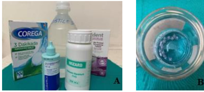
Resim 3.29. Örneklerin protez temizleme solüsyonlarında (A) bekletilmesi (B)
