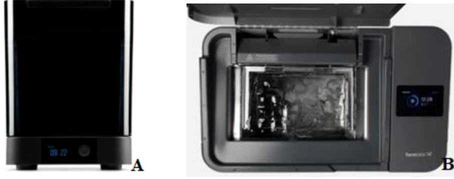
Resim 3.23. Örneklerin Form Wash cihazında (A) yıkanması (B)
