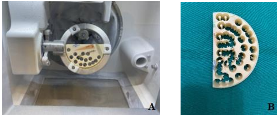
Resim 3.13. Silindir örnekler için prepolimerize blokun cihaza yerleştirilmesi (A) silindir örneklerin eldesi (B)
