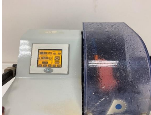
Resim 3.10. Prepolimerize rezin bloktan 2 mm kalınlıktaki plakaların elde edilmesi
