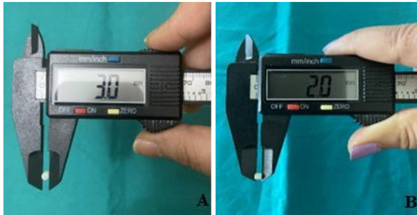
Resim 3.5. Akrilik diş örneklerinin çap (A) ve yüksekliklerinin (B) ölçülmesi
